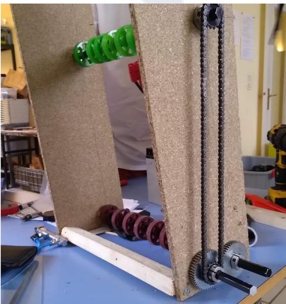
Nous avons réalisé un prototype d'un mécanisme permettant d'attraper les balles. Pour cela nous avons utilisé des roues *ANDYMARK green* et *maroon compliant wheels* ; motorisées par un *CIM*. Il nous a permis de tester l'écartement entre les roues et de vérifier si ce type de mécanisme fonctionnait pour attraper et expulser les balles.
